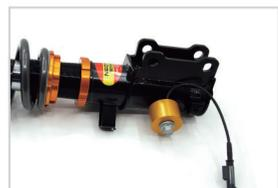
현대모비스 하네스 적용으로 고내구성, 장착 편의성 극대화. EDC(Electro damping control) 기능의 원리를 응용한 댐퍼 직접 체결식 캔슬러(Cancelation kit) 적용 (차종별로 상이할 수 있음)
